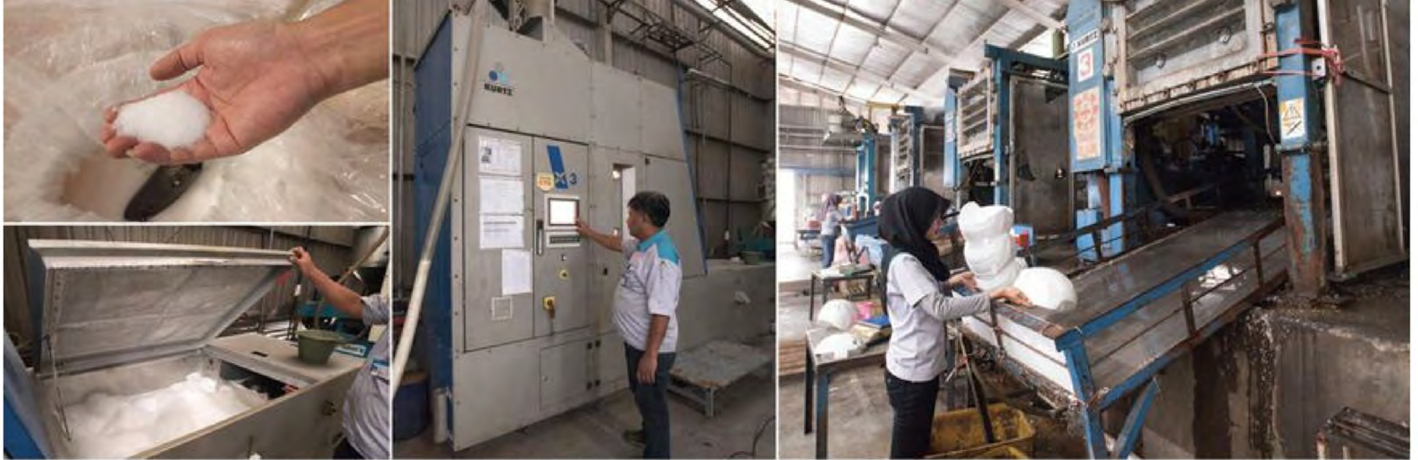
MOULAGE DES CALOTTES INTERNES EN EPS
