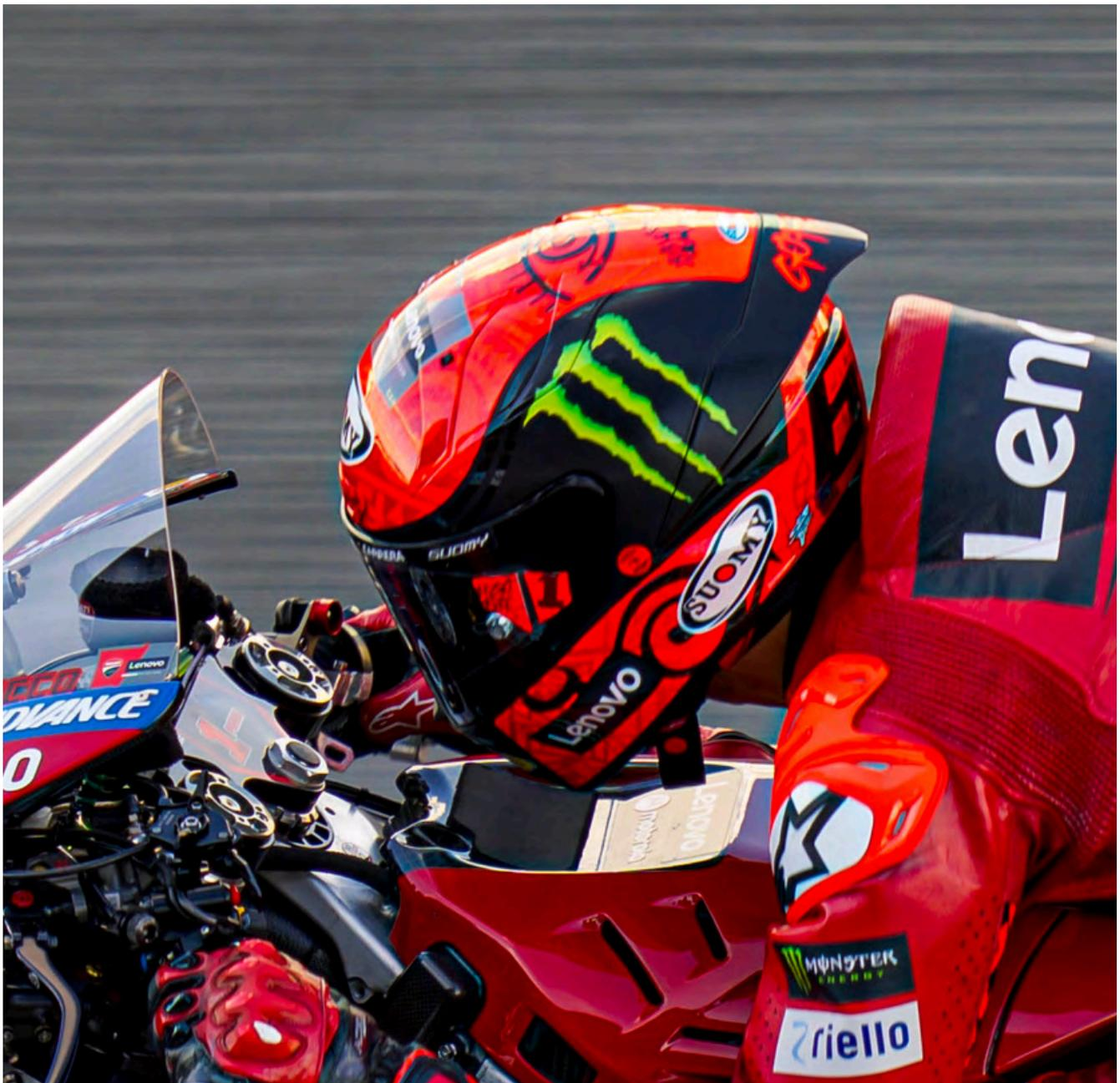
Pour ce qui est du spoiler, son profil aérodynamique agit dans le plan vertical, comme les déflecteurs agissent dans le plan horizontal : il réduit la traînée en retardant le point de décollement. Il crée aussi de la déportance : force qui maintient la tête du pilote vers le bas. Ainsi le pilote peut rester couché derrière sa bulle en fournissant moins d'effort.
